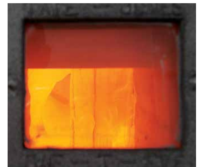
Под воздействием высоких температур при пожаре система PPG PITT-CHAR NX образует изолирующий слой
