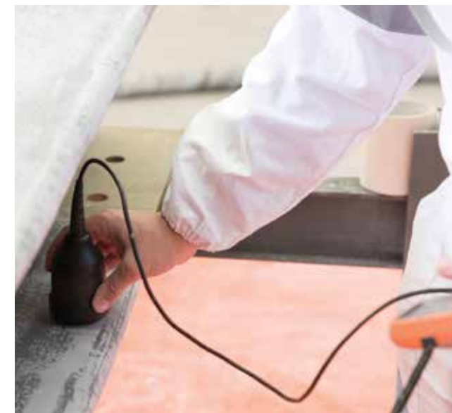
Толщина PPG PITT-CHAR NX по стандарту UL 1709 для 2-х часового предела огнестойкости составляет всего 7.98 мм
